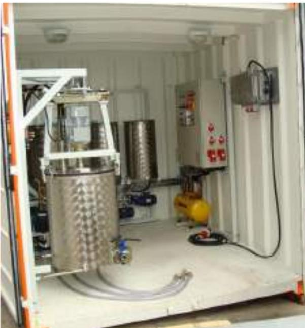
FL-DMR 3/60 im Containergehäuse integriert
